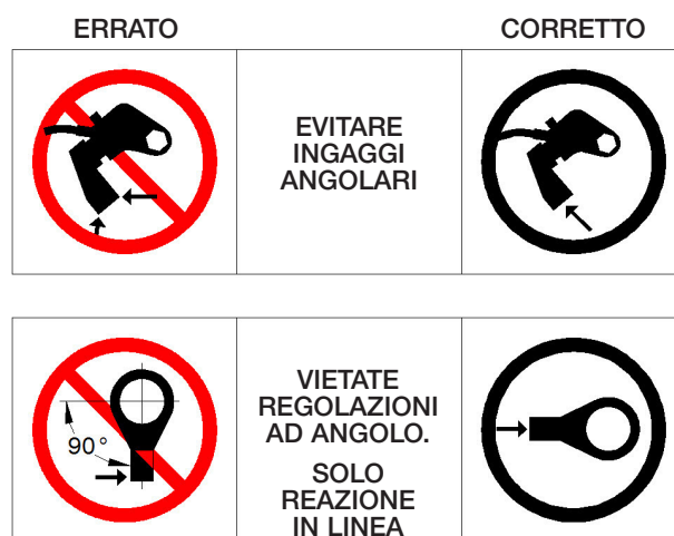
Fig 4.4-2 Reazione della chiave esagono passante con braccio di reazione
