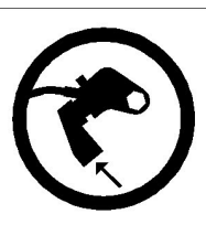
Рис. 4.4-2 Организация упора для гайковерта с шестигранной
