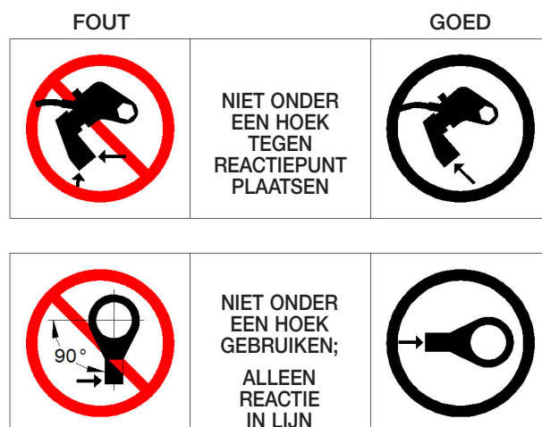
Figuur 4.4-2. Reactiemethode voor zeskantsleutel met reactiearm
