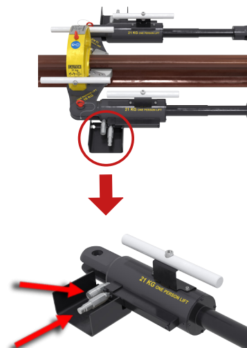
Рисунок 7: Подключение соединителей RP70A
