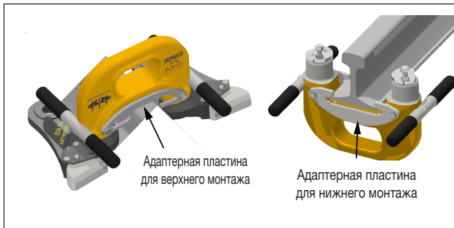
Рисунок 7: Адаптерные пластины для верхнего и нижнего крепления
