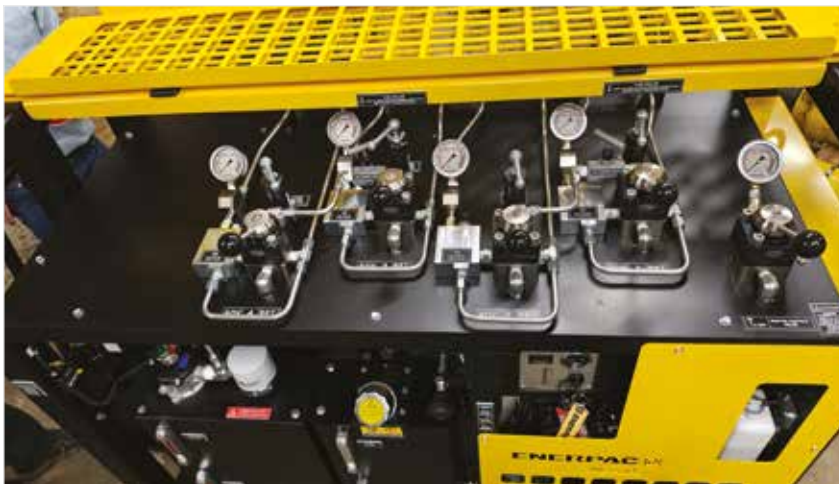
▲ 4方向3位置の手動制御バルブで単動または複動シリンダの前進、停止、後退を制御。回路ごとに調整可能リリースバルブと圧力ゲージ。
