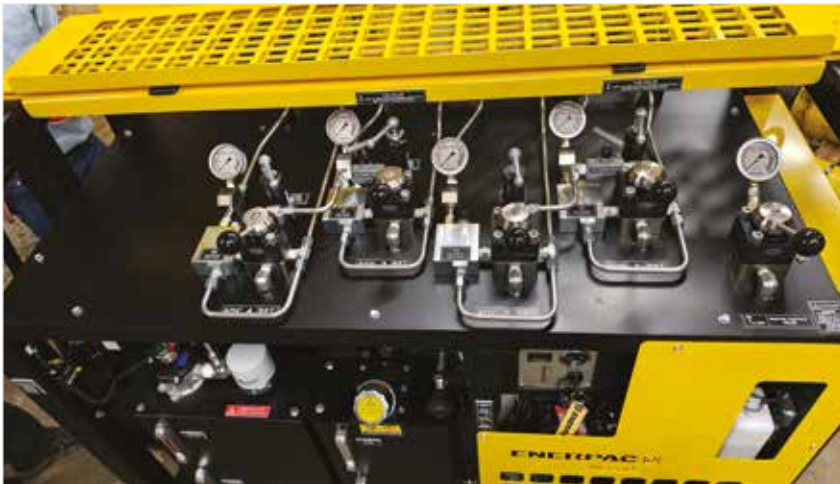
▲ 단동 또는 복동 실린더의 전진/유지/후진을 위한 4방향 3위치 수동 제어 밸브. 회로당 가변 압력 릴리프 밸브 및 압력 게이지.
