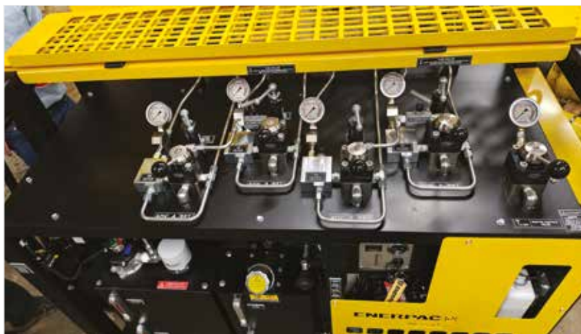
▲ 4-veis, 3-posisjons manuelle styreventiler for frem-/hold-/returfunksjon med enkelt- eller dobbeltvirkende sylindere. Justerbar trykksikkerhetsventil og trykkmanometere per krets.
