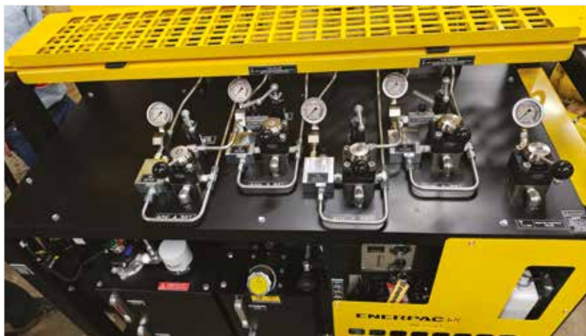
▲ Válvulas de controle manual de 4 vias e 3 posições para Avanço/Retenção/Retração de cilindros de simples ou dupla ação. Válvula de alívio de pressão ajustável e manômetros por circuito.
