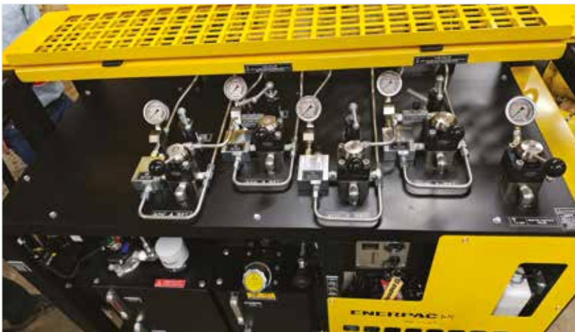
▲ 4-vägs, 3-läges manuella styrventiler för framåt-håll-bakåt av enkel- eller dubbelverkande cylindrar. Justerbar tryckbegränsningsventil och manometrar per krets.
