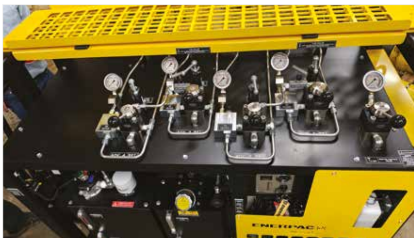
▲ Valvole di comando manuali a 4 vie e 3 posizioni per le funzioni di estensione/mantenimento/retrazione dei cilindri a semplice o doppio effetto. Valvola limitatrice di pressione regolabile per circuito.
