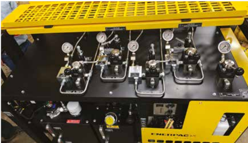
▲ Manuaaliset 4/3-tieasuuntaventtiilit yksi- tai kaksitoimisten sylinterien työliike/pito/vapautus-toimintoihin. Säädettävä paineensäätöventtiili ja painemittarit jokaisessa piirissä.
