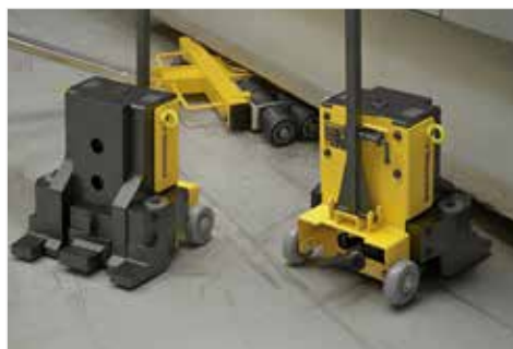
◀ Levage de machines à l'aide de crics à patte et déplacement horizontal à l'aide de patins rouleurs pour machine de la série MLS
