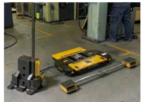
▲ 토우 잭을 이용한 장비 리프팅과 EMLS 시리즈 배터리 구동 머신 스케이트를 활용한 수평 이동.
