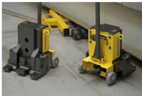
◀ Levantamento de máquinas com macacos de pedal e movimentação horizontal utilizando roletes de máquina com rodas da série MLS.
