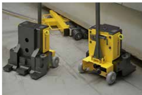
◀ Подъем оборудования с помощью домкратов с низким подхватом и горизонтальное перемещение с помощью катковых тележек серии MLS.
