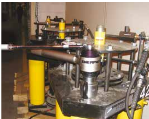
◀ Násobič krútiaceho momentu s reakčným ramenom E393 firmy Enerpac použitý na ručné ťahovanie skrutiek momentom do 4300 Nm.
