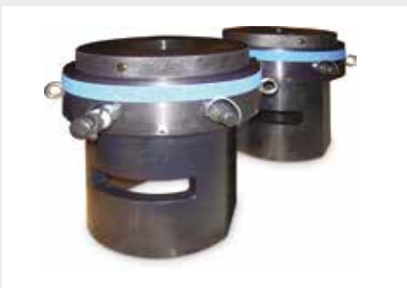
◀ Tensores hidráulicos personalizados adecuados para una salida de carga de 4200 kN en espárragos de 5 pulgadas.
