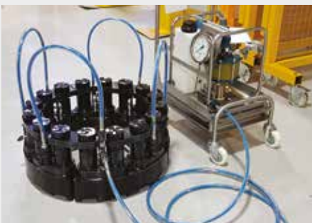
◀ Enerpac Multi Stud Tensioning (MST)-järjestelmä, joka pystyy jännittämään jokaisen nastan liitoksessa samanaikaisesti.
