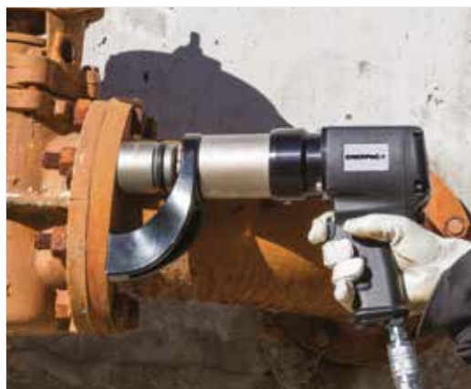
◀ PTW1000 nopeuttaa tätäkin laipan huoltotyötä.
