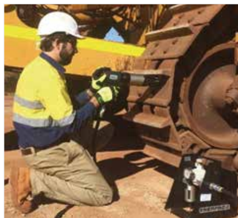
◀ PTW1000 nopeuttaa tätäkin laipan huoltotyötä.
