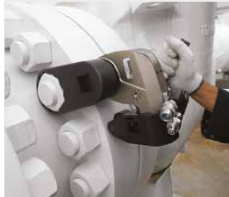
▲ Chiave dinamometrica S11000X modificata con inserto e rullo di reazione su misura.
