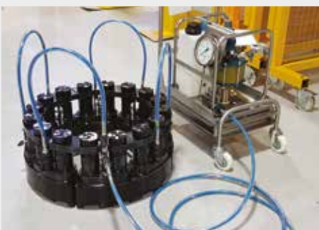
◀ Enerpac MST-systeem (Multi Stud Tensioning) dat alle bouten van een boutverbinding gelijktijdig kan spannen.
