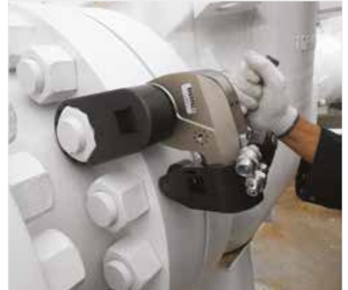
▲ Tilpasset S11000X momenttrekker med tilpasset momentledd og reaksjonsrulle.
