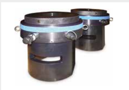
◀ Tensionadores hidráulicos personalizados para atender prisioneiros de 5 polegadas com saída de carga de 4200 kN.
