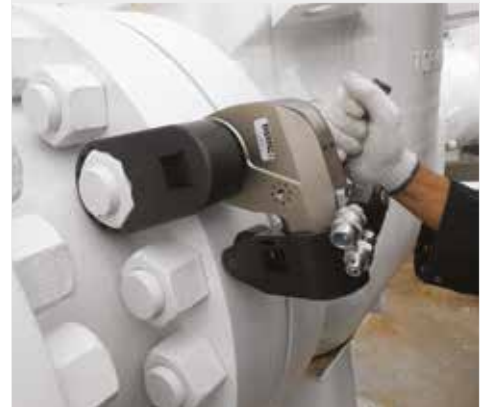
▲ Chave de torque S11000X personalizada com um link de torque personalizado e rolo de reação.
