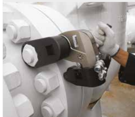
▲ Cheie dinamometrică S11000X personalizată cu articulație și rolă de reacție personalizate.
