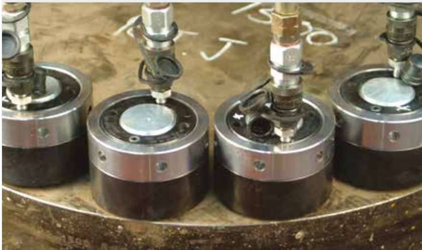
▲ Tensionarea cu piulițe hidraulice.
