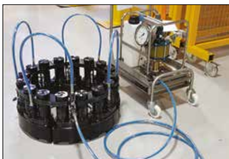
◀ Система одновременной затяжки шпилек Enerpac (MST) способна одновременно выполнять затяжку всех шпилек в соединении.
