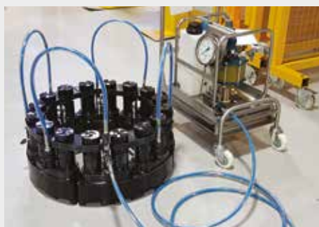
◀ Enerpac MST-system (Multi Stud Tensioning) som kan spänna varje bult i ett förband samtidigt.
