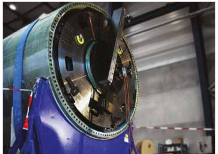
▼ Fresado del extremo del álabe de una turbina con WP3500.
