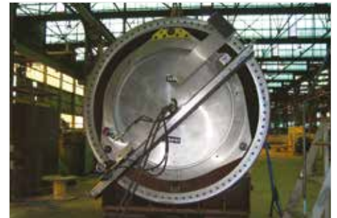
▼ Mecanizado de torre eólica con WP4600.
